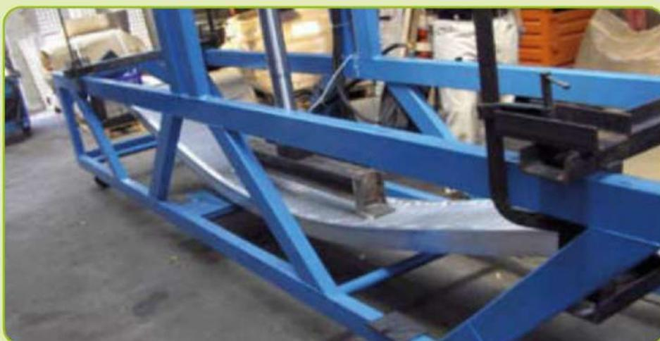
*Rampa sottoposta a rottura.*
