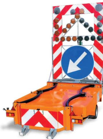
Esempi di figura 12 (segnale mobile di preavviso integrato con Alta Visibilità) e 17 (assorbitore d'urto abbinato al segnale mobile di protezione) del Disciplinare ASPI
