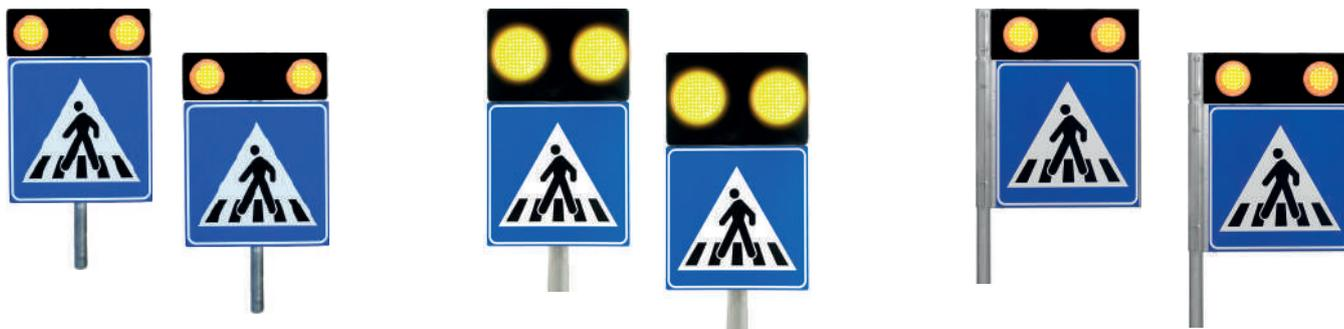
**Fig. 1:** 4 targhe 60x60 cm in lamiera classe I fig. 303 + 2 pann. int. 60x20 cm alluminio classe I con lampegg. doppio Ø 100 mm tri-flash
