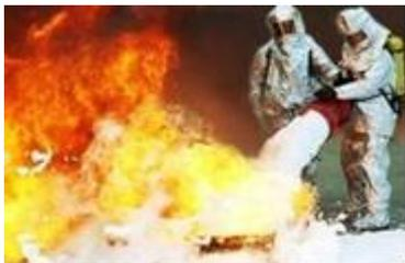
Il liquido schiumogeno **PROSINTEX** è composto da una particolare formulazione di tensioattivi non fluorurati e sali stabilizzanti che permettono di ottenere schiume ad elevata plasticità e scorrevolezza in grado di sigillare rapidamente vaste aree, anche in presenza di ostacoli, limitando l'evaporazione dei gas combustibili.
