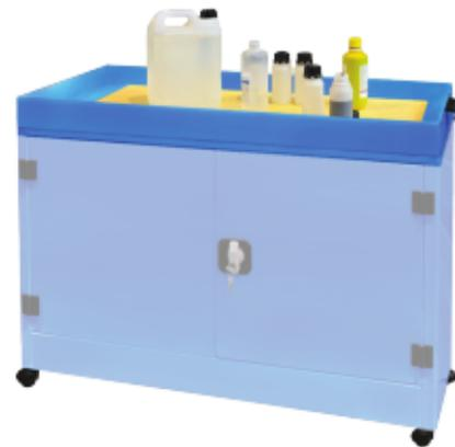
Armadio di sicurezza componibile per lo stoccaggio di liquidi chimici, realizzato in lamiera di acciaio al carbonio P02 spessore 10/10, pre-trattato con fosfosgrassaggio in tunnel ad alte temperature. Verniciatura con innovativo e speciale materiale termoplastico a base polietilene che permette un rivestimento di alto spessore adatto alla resistenza agli agenti chimici corrosivi, BLU RAL5015, e cottura in galleria termica 180°.
