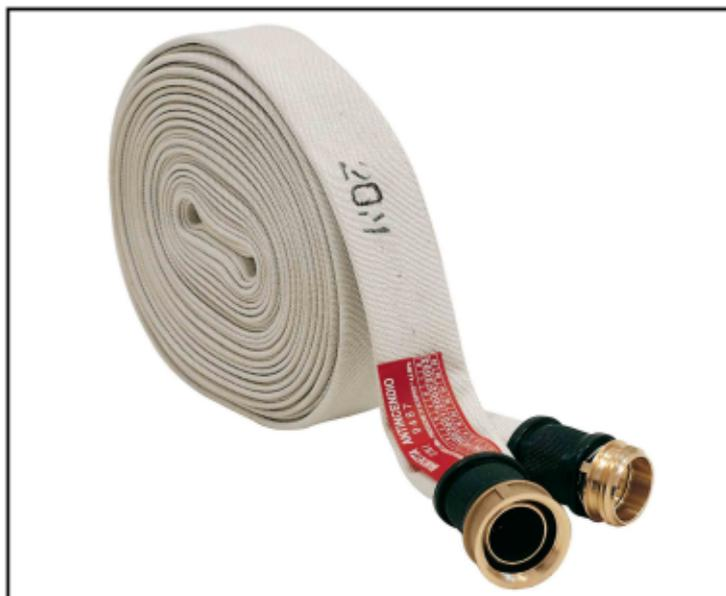
La manichetta antincendio modello "UNI BRUX" è composta da un tessuto circolare di poliestere ad alta tenacità con un sottostrato impermeabilizzante elastometrico senza sovrapposizioni per minimizzare le perdite di carico. L'alta resistenza all'ozono ed all'invecchiamento la rendono la manichetta ideale per chiunque voglia un prodotto di lunga durata.
