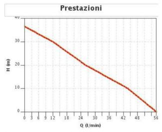
caratteristiche riferite al funzionamento con acqua a 20°
