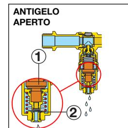
La sede di scarico del dispositivo antigelo è in acciaio inox, per garantire l'ermeticità del dispositivo, senza problemi di corrosione dovuta al contatto con l'acqua di scarico.
