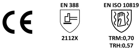
è conforme alla pertinente legislazione di armonizzazione dell'Unione, Regolamento UE 2016/425, in materia di attrezzature protettive personali e alle normative armonizzate europee EN 388:2016, EN ISO 10819:2013/A1:2019.
