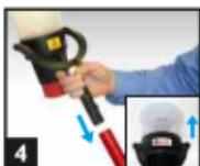
4 Inserire il Solo 330 nel palo. Posizionare il Solo 330 sopra al rivelatore, assicurando una buona tenuta intorno alla camera di test.
