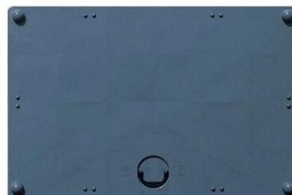
La sovrapposizione è assicurata da 4 spine cilindro/sferiche ricavate direttamente da stampo sulla parte superiore del contenitore, che si incastrano inopportune sedi ricavate sul fondo dei piedini/travette del contenitore stesso. I 35 mm di incasso garantiscono la massima sicurezza e stabilità della sovrapposizione.
