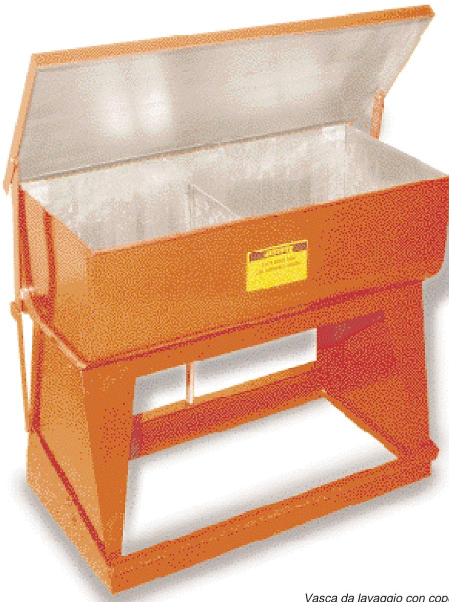
*Vasca da lavaggio con coperchio a pedale e autochiudente per trattenere i vapori infiammabili e spegnere i principi di incendio.*
